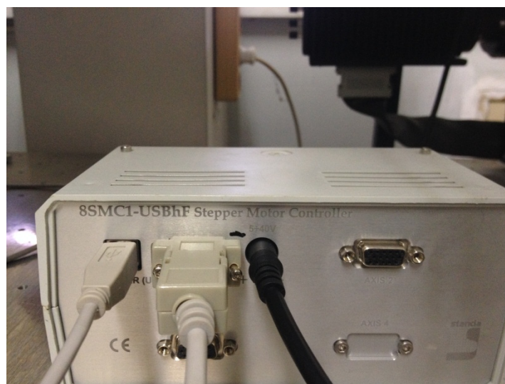
Σχήμα 3.7 Το σύστημα οδήγησης του αντικειμενοφόρου τράπεζας. Διακρίνονται οι τρεις θύρες για τον έλεγχο στους τρεις άξονες xyz (όπως φαίνεται στη φωτογραφία, χρησιμοποιήθηκε μόνο η μία θύρα, για τον άξονα x). Το μαύρο καλώδιο είναι η τροφοδοσία της συσκευής, ενώ το καλώδιο στ' αριστερά (USB) εξυπηρετεί στη σύνδεση της συσκευής με τον υπολογιστή.
