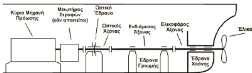
Εικόνα 5.2: Σχηματική αναπαράσταση αξονικού συστήματος πλοίου
