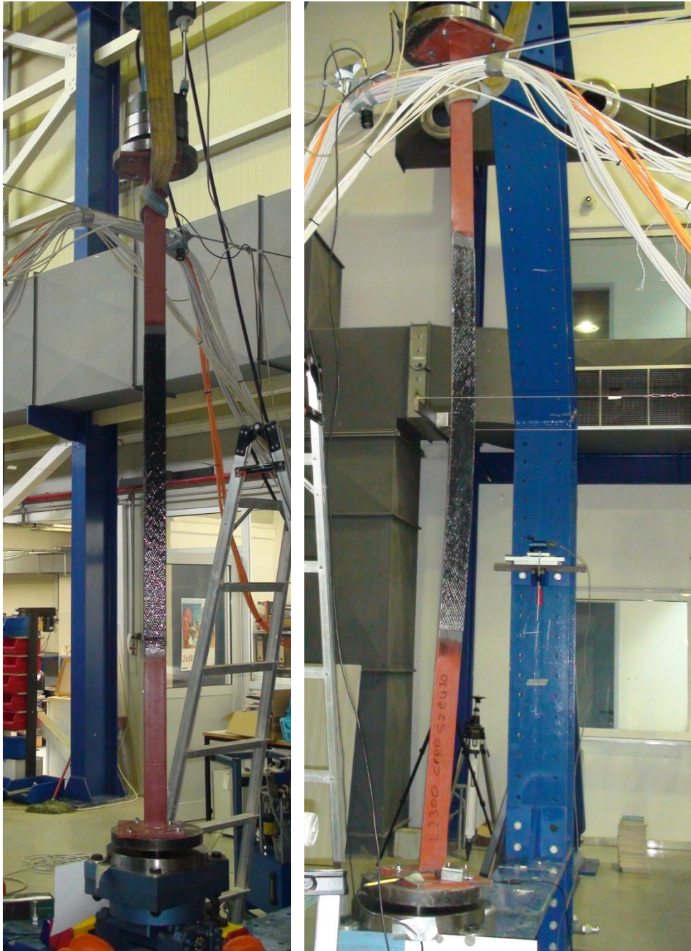
Σχήμα 5.15: Γενική άποψη πειραματικής διάταξης θλίψης για το δεύτερο δοκίμιο, στην απαραμόρφωτη (αριστερά) και στην παραμορφωμένη (δεξιά) του κατάσταση
