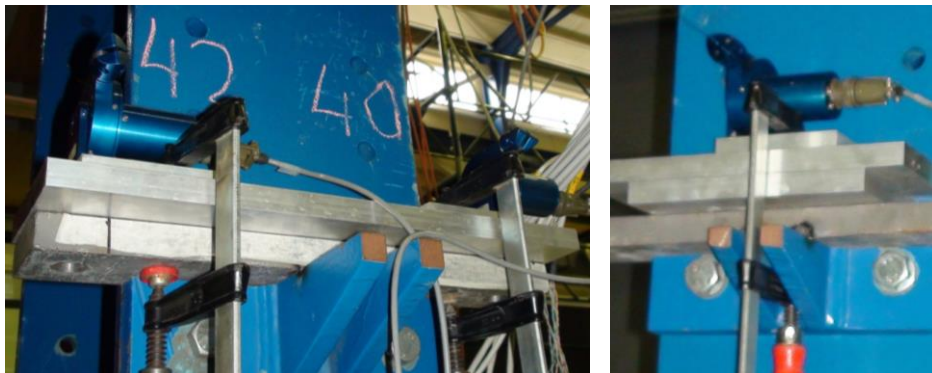
Σχήμα 5.2: Η διάταξη των τριών wires που χρησιμοποιήθηκαν για καταγραφή των μετατοπίσεων
