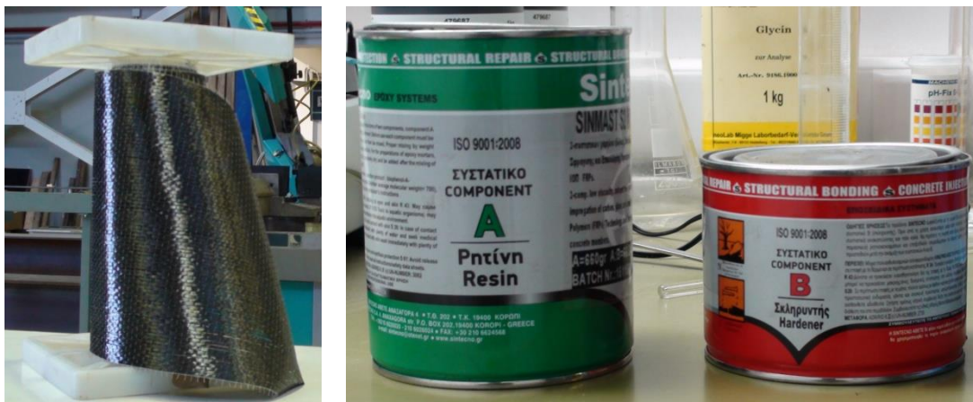
Σχήμα 4.3: Ύφασμα ινών άνθρακα μονής διεύθυνσης (αριστερά) και συστατικά εποξειδικής ρητίνης εμποτισμού (δεξιά) που χρησιμοποιήθηκαν στη δημιουργία των δοκιμίων σύνθετου υλικού
