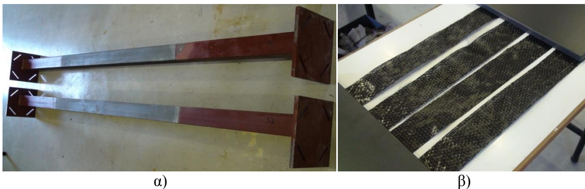
Σχήμα 5.5: α) Οι δύο χαλύβδινες δοκοί μετά την αμμοβολή των επιθυμητών επιφανειών τους και β) 4 λωρίδες ινών άνθρακα μετά την κοπή τους στις επιθυμητές διαστάσεις
