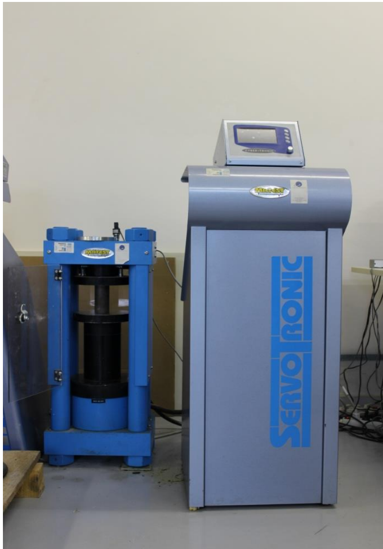
Εικόνα 5.1 Συσκευή θλίψης (πρέσσα) και σερβομηχανή για την επιβολή του φορτίου με σταθερό ρυθμό
