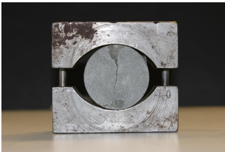
Εικόνα 5.4 Δοκιμή δίσκου (Brazilian test). Δοκίμιο μετά την επιβολή φορτίου αστοχίας.
