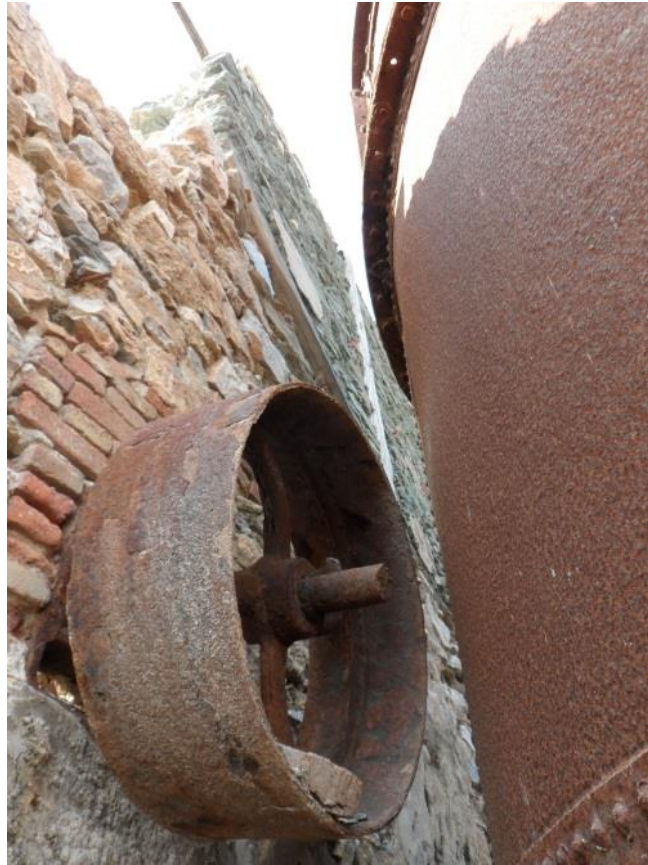
Εικόνα 60: Η κατάληξη του άξονα κίνησης πίσω από τον σαπωνολέβητα (πηγή: προσωπικό αρχείο)
