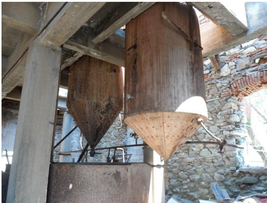
Εικόνα 37: Δεξιά ο αποχρωματιστής και αριστερά το καζάνι μερικής σαπωνοποίησης οξέων από την ραφινερία στον Άγιο Ισίδωρο (πηγή: προσωπικό αρχείο)
