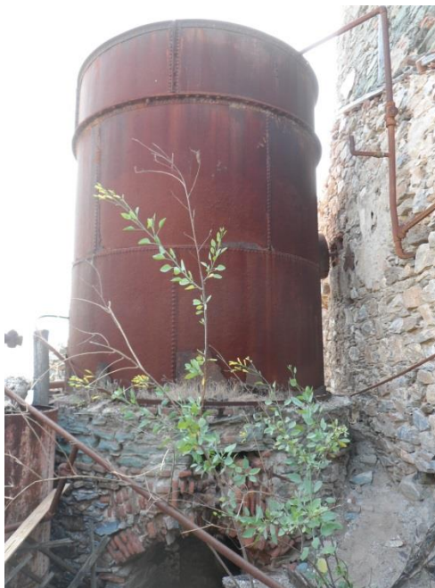
Εικόνα 21: Σαπωνολέβητας από το σαπωνοποιείο στον Άγιο Ισίδωρο (πηγή: προσωπικό αρχείο)
