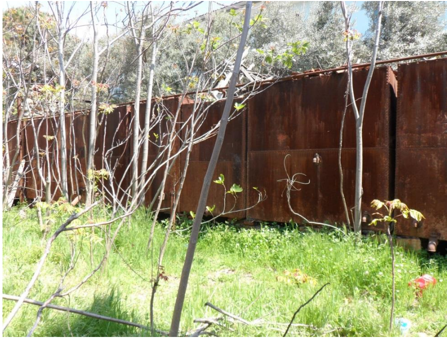
Εικόνα 62: Αποθηκευτικά δοχεία λαδιού σε παράταξη στον βορειοανατολικό μαντρότοιχο του συγκροτήματος, διακρίνεται αριστερά ένα μεταλλικό υποστυλώμα του στεγάστρου που υπήρχε στο σημείο και είναι μεταγενέστερο, στην αρχική φάση μπορεί να υπήρχε στην θέση αυτή κάποιο ξύλινο στέγαστρο (πηγή: προσωπικό αρχείο)
