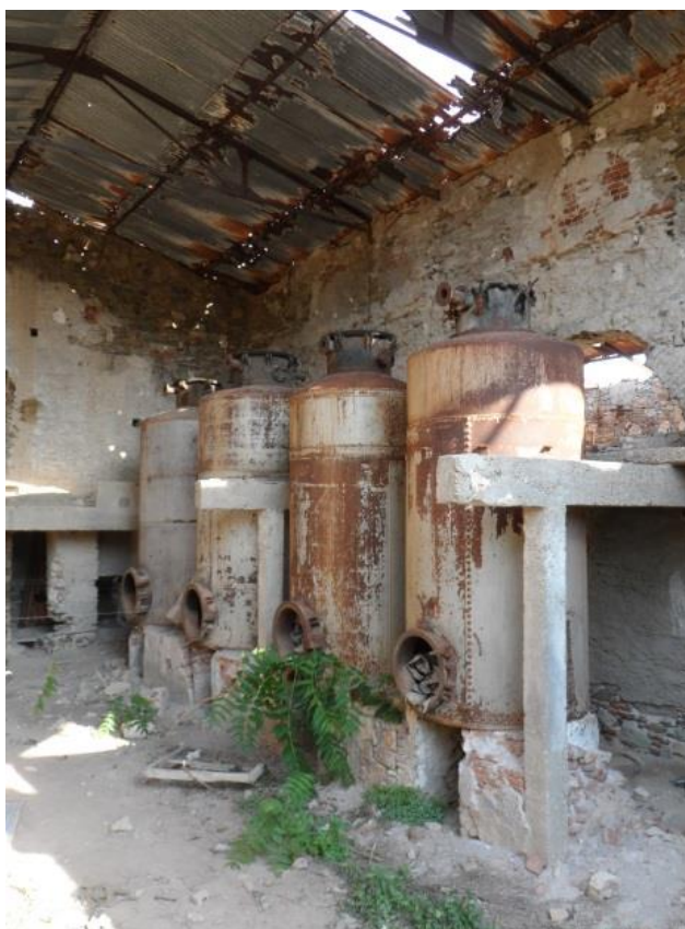
Εικόνα 13: Εκχυλιστήρες σε παράταξη από το πυρηνελαιουργείο στον Άγιο Ισίδωρο (πηγή: προσωπικό αρχείο)
