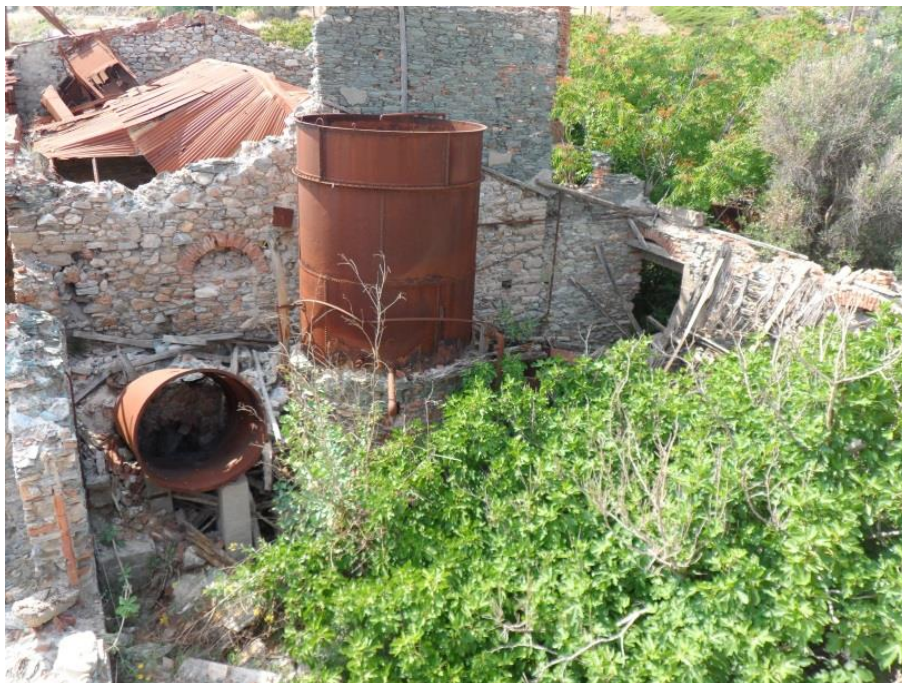
Εικόνα 64: Οι δύο σαπωνολέβητες που σώζονται και πιθανώς ανήκουν στην επόμενη φάση (πηγή: προσωπικό αρχείο)
