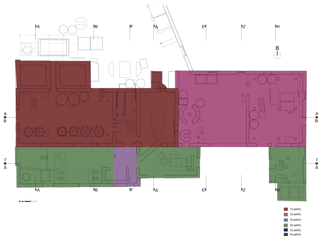
Εικόνα 93: Οι οικοδομικές φάσεις στην κάτοψη του ισογείου
