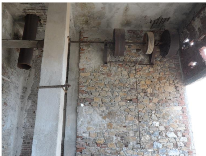
Εικόνα 19: Άξονας κίνησης από την ραφινερία στον Άγιο Ισίδωρο (πηγή: προσωπικό αρχείο)
