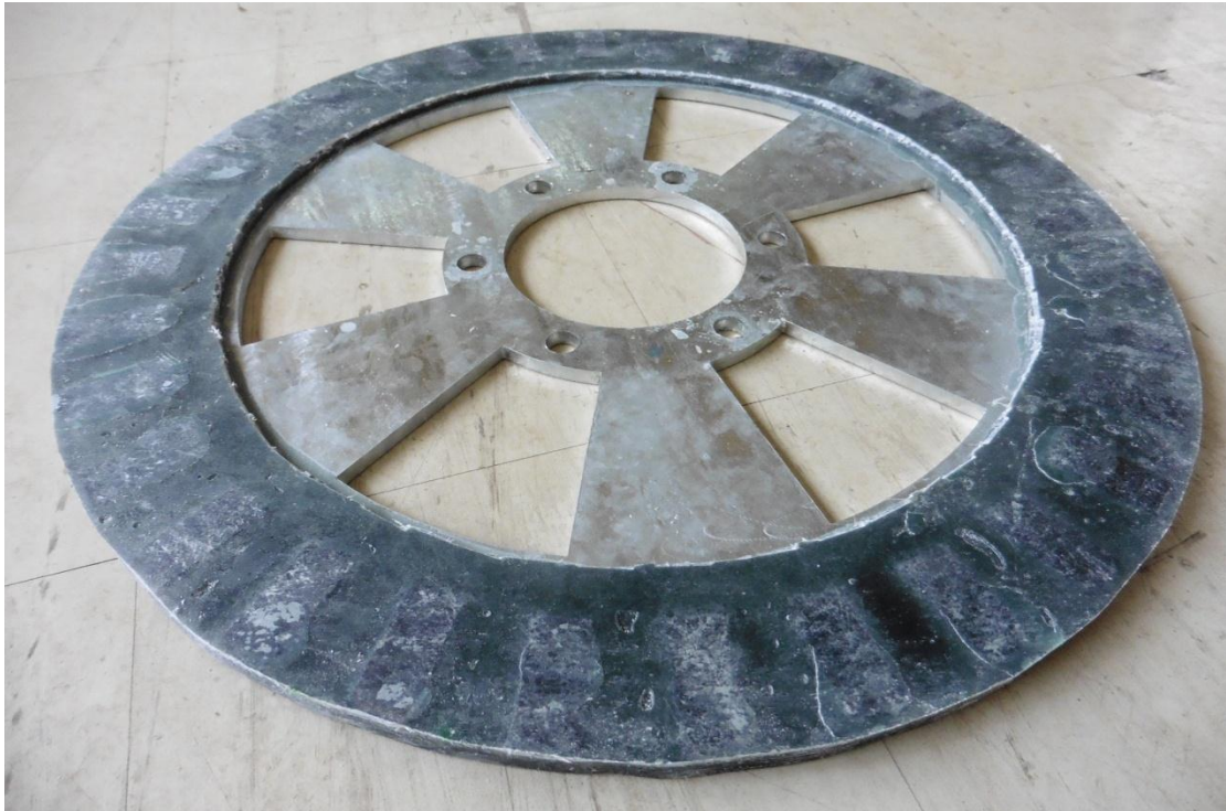
Σχήμα 7.7. Ο ένας σιδερένιος δίσκος με τους μαγνήτες και τη ρητίνη αφού έχει λιμαριστεί. Οι δρομείς είναι έτοιμοι.
