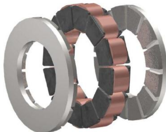
Σχήμα 2.6. Στάτης χωρίς πυρήνα
