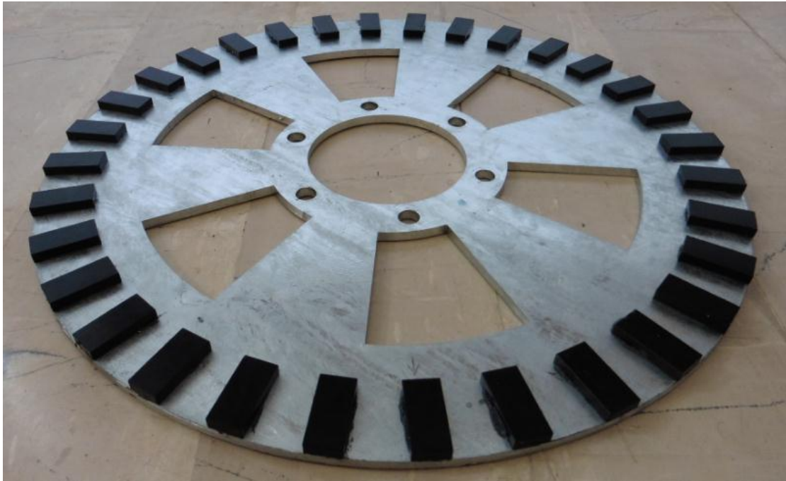
Σχήμα 7.3. Ο δίσκος μετά τη στερέωση των μαγνητών
