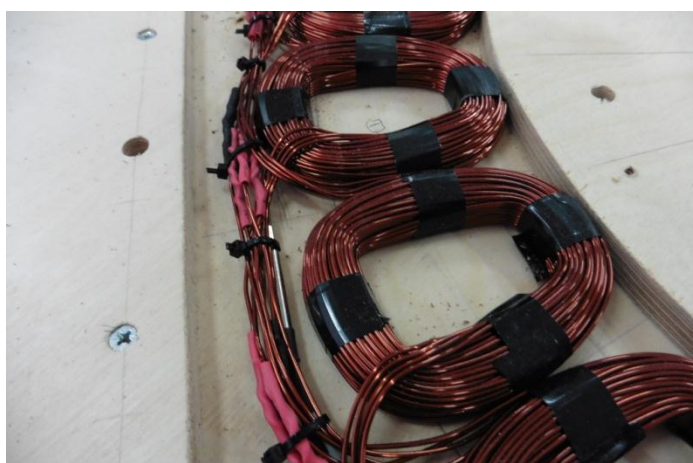
Σχήμα 7.10. Η σύνδεση σε αστέρα και τα θερμοσυστελλόμενα στα σημεία όπου τα άκρα των πηνίων συνδέονται με κολλητήρι και καλάι. Δεξιά η σύνδεση σχηματικά από το Recipe Book.
