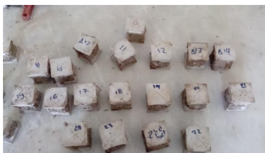
Φωτογραφία 6.7. 'Καπέλωμα' των δοκιμίων με λεπτή στρώση γύψου
