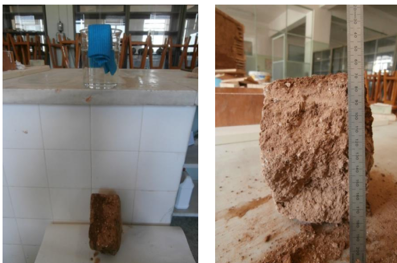
Φωτογραφία 6.11. Τοποθέτηση της ωμόπλινθου και βάθος διείσδυσης νερού, κατά την τεχνική Geelong
