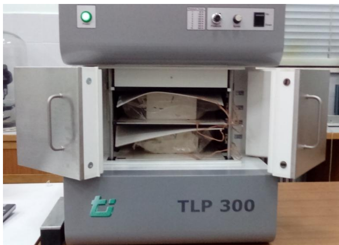
Φωτογραφία 6.10. Τοποθέτηση 2 δοκιμών με αεροστεγανό περίβλημα (συμμετρική μέτρηση).
