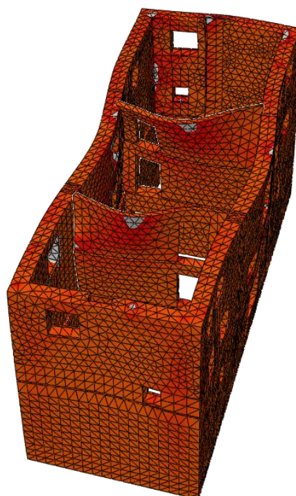
Εικόνα 7.12. Η υπέρβαση της εφελκυστικής αντοχής της τοιχοποιίας σημειώνεται με χρώμα γκρι (στιγμιότυπα από τον σεισμό Μπίτολα)
