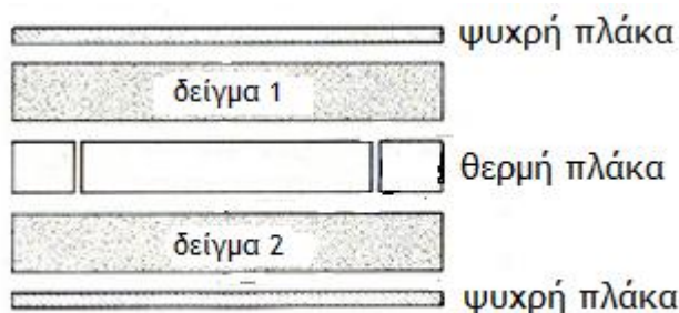
Εικόνα 6.1. Σχηματική αναπαράσταση διάταξης μέτρησης θερμικής αγωγιμότητας
