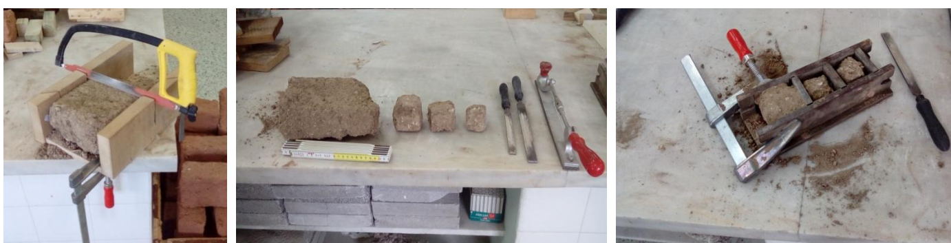
Φωτογραφία 6.6. Κοπή και διαμόρφωση των τελικών δοκιμίων.
