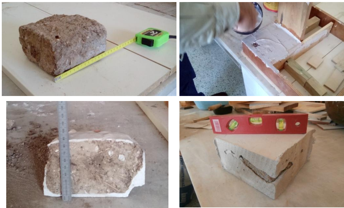
Φωτογραφία 6.9. Κοπή ωμόπλινθου σε κατάλληλες διαστάσεις, 'καπέλωμα' με γύψο για τη δημιουργία λείας επιφάνειας με προσοχή ώστε το τελικό πάχος του γύψου να είναι το ελάχιστο δυνατό.
