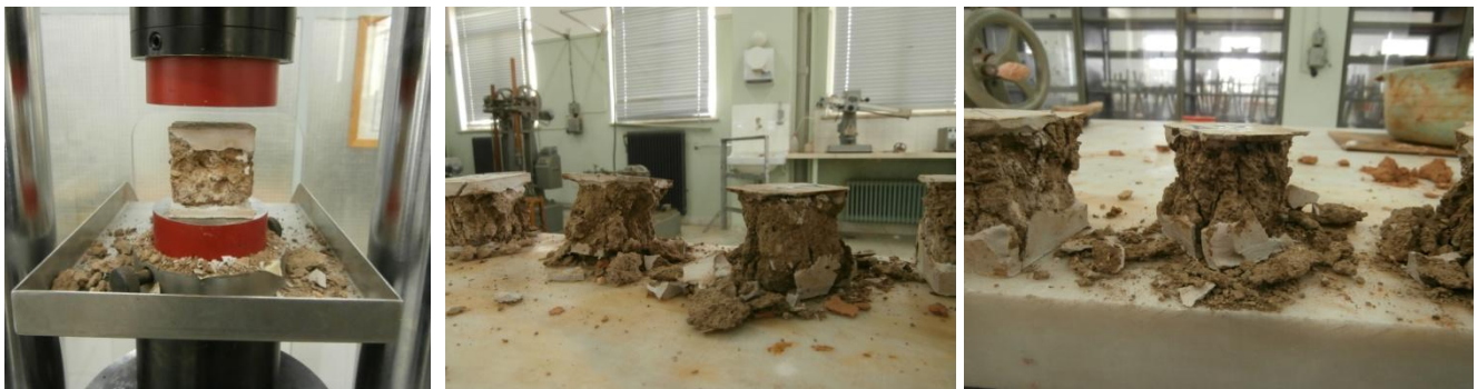
Φωτογραφία 6.8. Τοποθέτηση στη συσκευή και εικόνα θραύσης ορισμένων δοκιμών.
