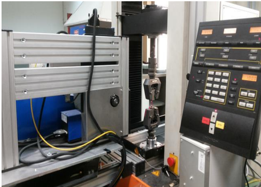
Εικόνα 28: Πειραματική διάταξη για τις δοκιμές εφελκυσμού (INSTRON 1121).
