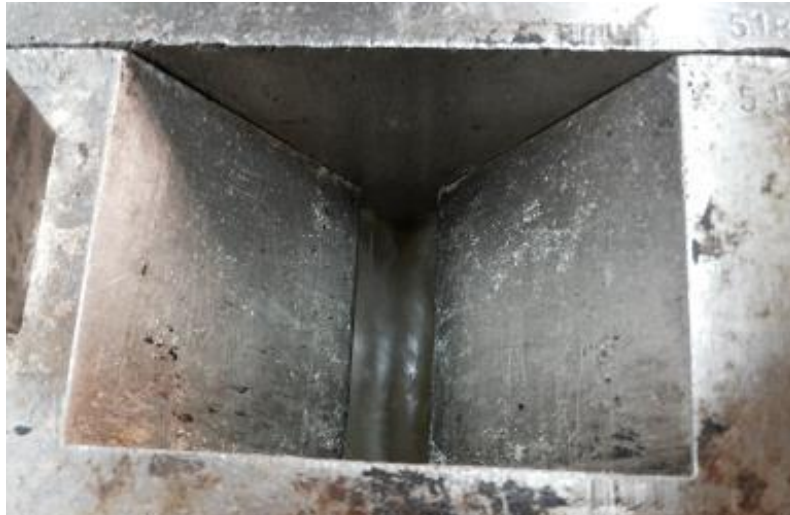
Εικόνα 20: Το “παράθυρο” ανάδευσης, από όπου εισάγονται τα υλικά, σε πραγματικές συνθήκες λειτουργίας.
