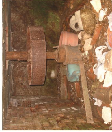
φωτογραφία 5 Ιουνίου 1993, αρχείο Στέφανου Νομικού είναι εμφανής η μύλoπετρα και το ξύλινο πατάρι εντοπίζεται αριστερά και τμήμα ζευκτού της οροφής. Σε λεπτομέρεια κάτω αριστερά, το λογότυπο της πέτρας της γαλλικής βιομηχανίας μύλοπετρών Soci te Generale Meuliere (1884-1951).
