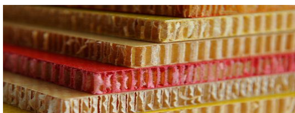
Σχ. 1.2(Σύνθετο υλικό τύπου sandwich)
