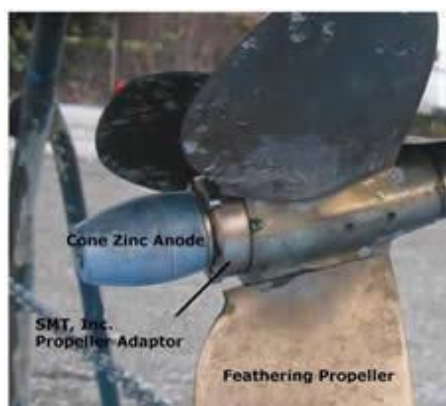
Εικόνα 4.2: Προστασία με θυσιαζόμενες ανόδους έλικας πλοίου
