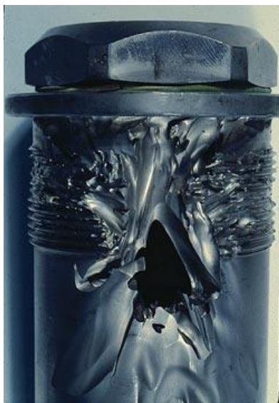
Εικόνα 1.12: Διάβρωση βίδας λόγω έντονου χημικού περιβάλλοντος.
