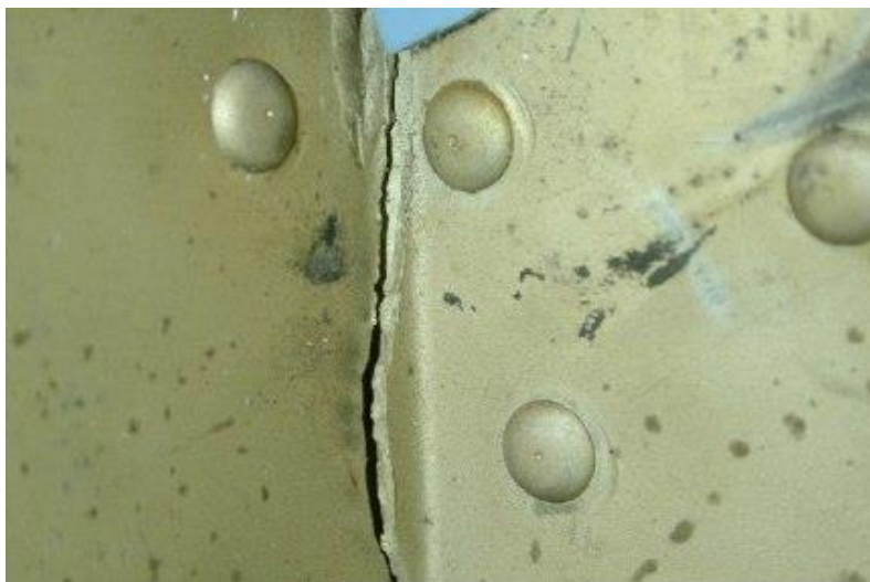
Εικόνα 1.3: Διάβρωση με μηχανική καταπόνηση τμήματος αεροπλάνου
