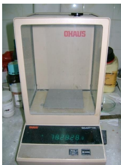
Εικόνα 7.8: Ζύγισμα δοκιμίου μετά τον καθαρισμό αλλά πριν την βαφή.
