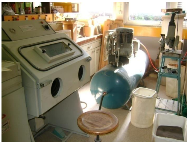
Εικόνα 7.7: Διάταξη μηχανήματος ψηγματοβολής
