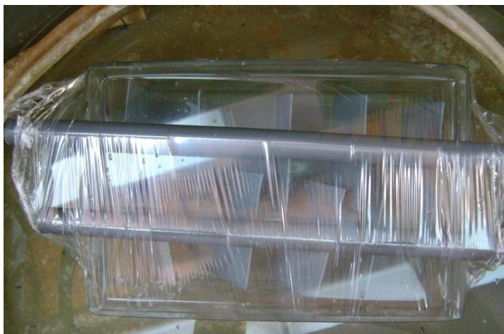
Εικόνα 7.11: Λεκάνη εμφάπτισης σκεπασμένη με διαφανή μεμβράνη σε δοκίμια ψευδάργυρου
