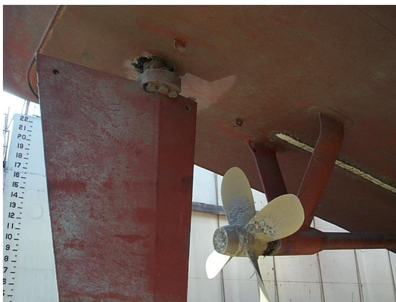
Εικόνα 1.11: Διάβρωση πηδαλίου και έλικας λόγω θαλασσινού περιβάλλοντος
