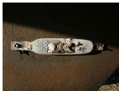
Εικόνα 4.2: Προστασία με θυσιαζόμενες ανόδους έλικας πλοίου
