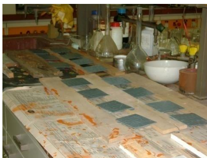
Εικόνα 7.10: Δοκίμια με επίστρωμα με επίστρωμα ψευδαργύρου.
