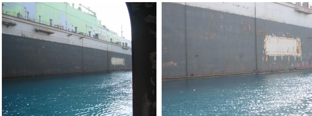
Εικόνα 6.2: Πλωτής Δεξαμενής που έχει υποστεί διάβρωση στα πλάγια και έχει συντηρηθεί με αμμοβολή και βαφή τοπικά (στο σημείο που φαίνεται με γκρι).
