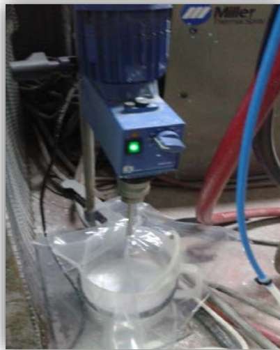
Σχήμα 7.4 -Διάταξη τροφοδοσίας αιωρήματος κατά τον υγρό θερμικό ψεκασμό.
