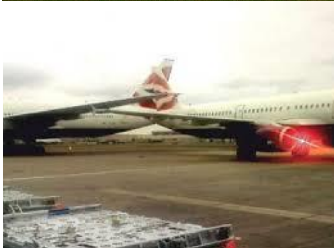
Σχήμα 1.2 Παραδείγματα σύγκρουσης φτερών αεροσκαφών με κινητά ή σταθερά εμπόδια
