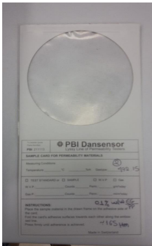
Εικόνα 2-18: Ειδική κάρτα για την εισαγωγή του δείγματος στη συσκευή μέτρησης για τη διαπερατότητα του οξυγόνου
