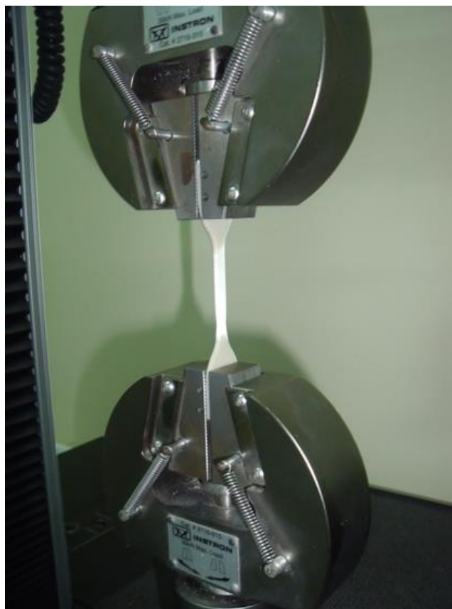
Εικόνα 2-22: Πραγματοποίηση πειραμάτων εφελκυσμού με τη συγκεκριμένη συσκευή Instron
