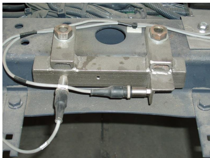
Εικόνα 2.7-4: Επιταχυνσιόμετρα HBM B12 Μετρώντας (α) Διαμήκη Επιτάχυνση (β)Εγκάρσια Επιτάχυνση
