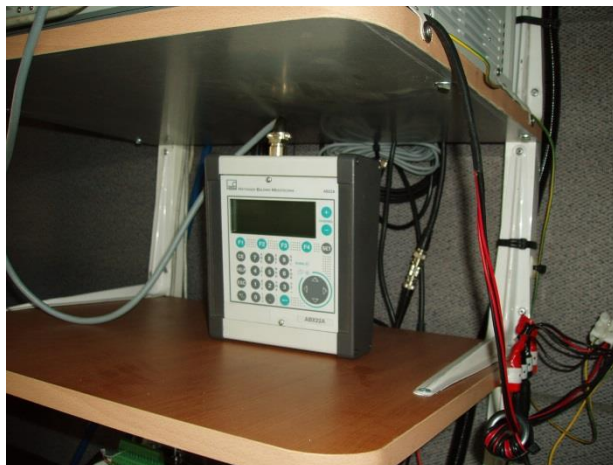
Εικόνα 2.3-2: (β)Κεντρική Μονάδα Συλλογής Δεδομένων-MGCrplus
