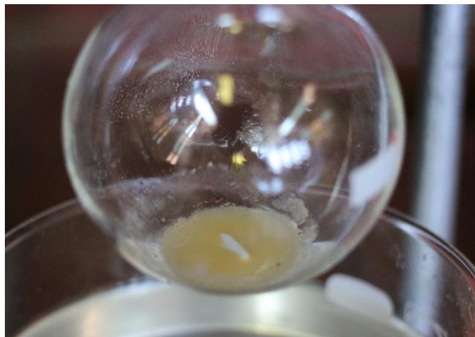
Εικόνα 4.2.4, Κίτρινο ζελέ- Φαινόμενο ζελαρίσματος της δομής του πολυμερούς
