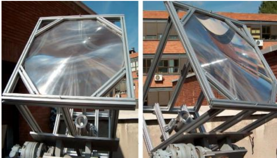
Σχήμα 48: Εμπορική εκδοχή φακού Fresnel
