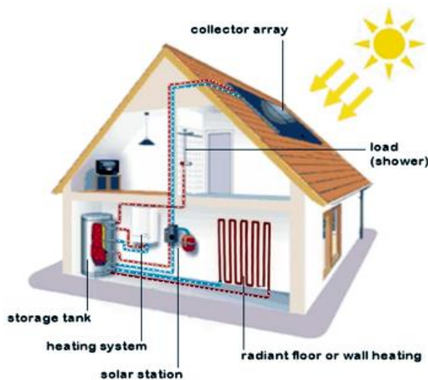
Σχήμα 25: Ενδεικτικό λειτουργικό διάγραμμα συστήματος combi
