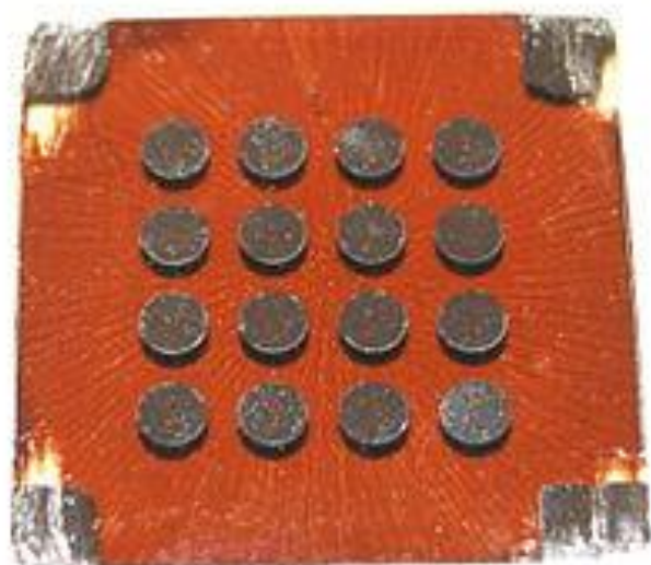
Σχήμα 36: Quantum dot φωτοβολταϊκή κυψέλη
