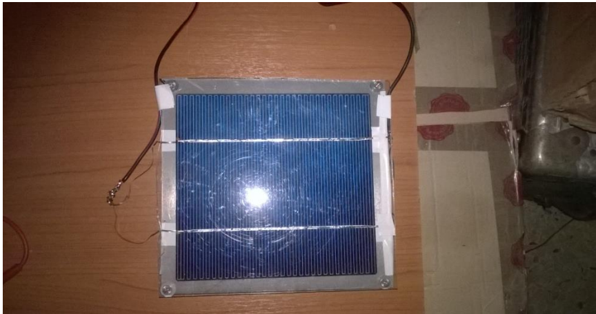
Σχήμα 69: Φωτοβολταϊκή κυψέλη τοποθετημένη πάνω στην πλάκα αλουμινίου
