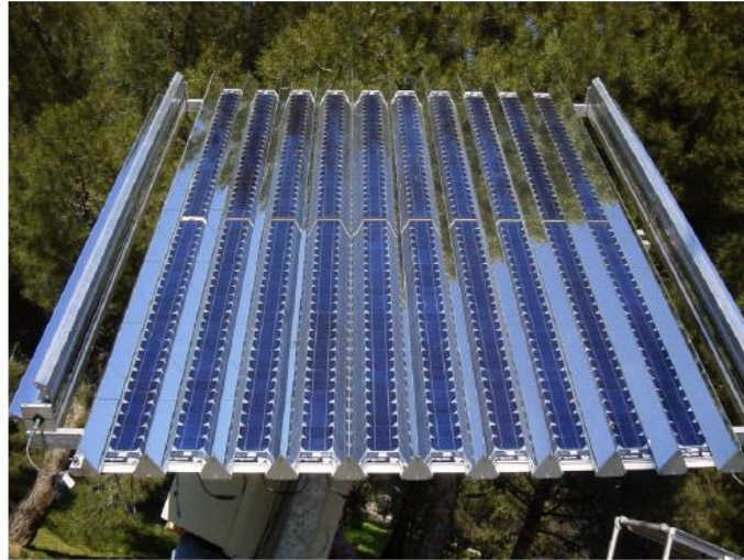
Σχήμα 50: Πιλοτική εγκατάσταση συγκεντρωτών τύπου V στην Κρήτη
