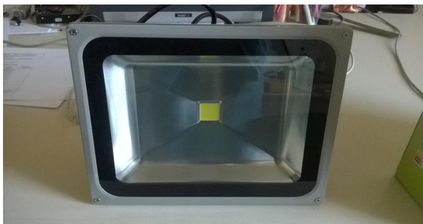
Σχήμα 68: Προβολέας LED που χρησιμοποιήθηκε για τη διεξαγωγή των πειραμάτων σε εσωτερικό χώρο
