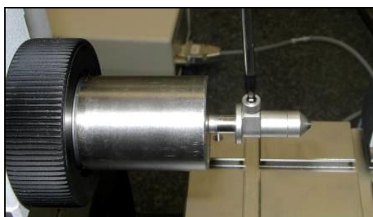
Σχήμα 7: Τοποθέτηση-σύσφιξη ακίδων επαφής
