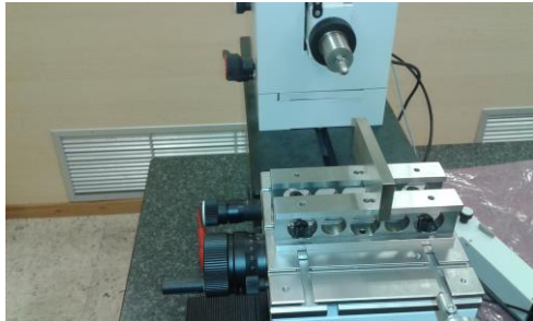
Σχήματα 13, 14: Τοποθέτηση δοκιμίου 90mm στις βοηθητικές βάσεις
