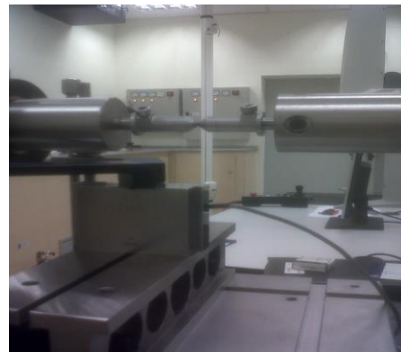
Σχήματα 18 , 19: Ευθυγράμμιση Ακίδων Επαφής
