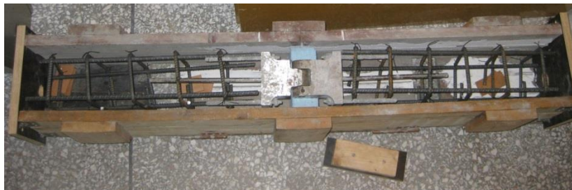
Σχήμα 3.1 Δοκίμιο πριν τη σκυροδέτηση με τον καμπτικό και διατμητικό οπλισμό
