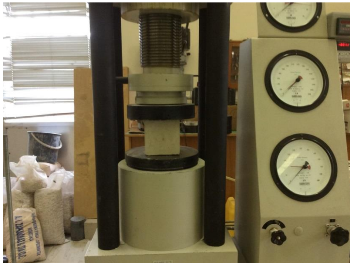
Σχήμα 3.11 Δοκιμή θλίψης κυβικού δοκιμίου
