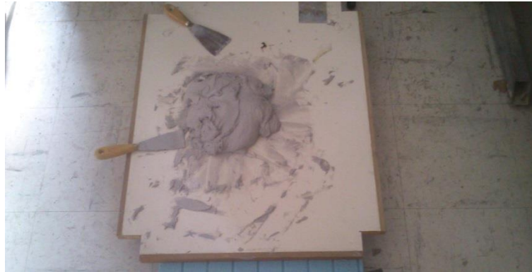
Σχήμα 3.5 Ανάμιξη των δυο συστατικών της εποξειδικής ρητίνης
