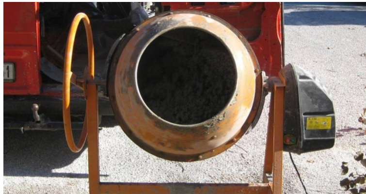
Σχήμα 3.7 Παρασκευή σκυροδέματος στον αναδευτήρα
