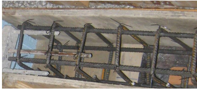
Σχήμα 3.2 Λεπτομέρειες καμπτικού και διατμητικού οπλισμού σε δοκίμιο
