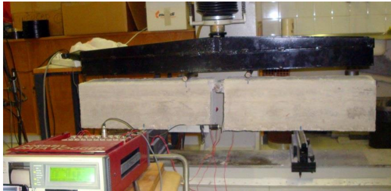
Σχήμα 3.17 Η δοκός-δοκίμιο στη μηχανή κάμψης
