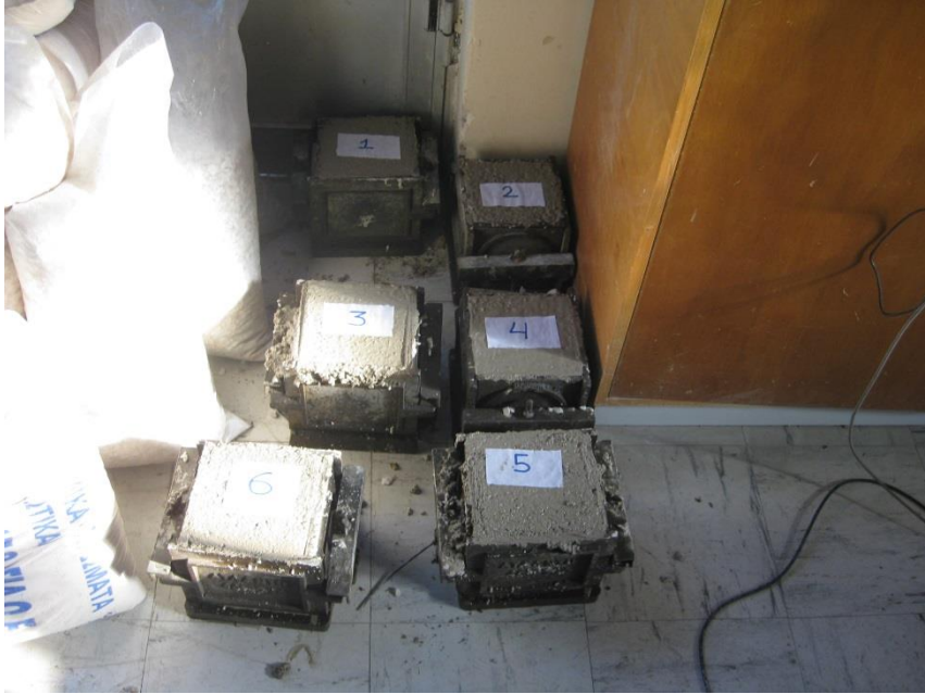
Σχήμα 3.10 Κυβικά δοκίμια αμέσως μετά τη σκυροδέτηση
