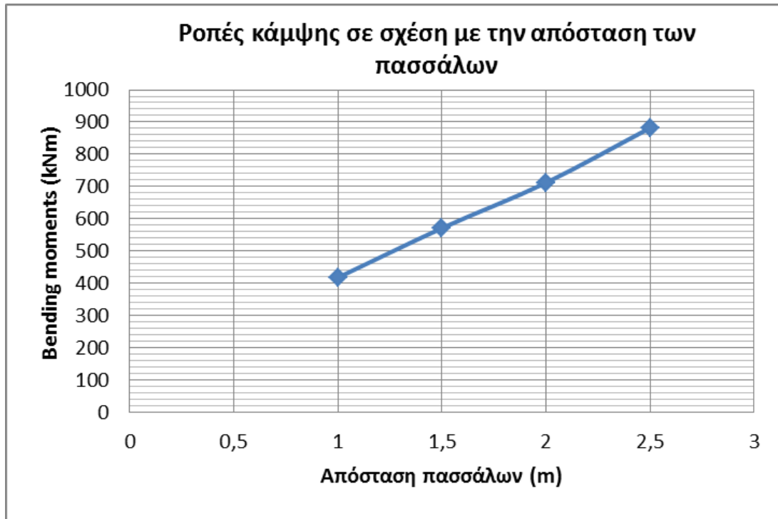
Διάγραμμα 6.5. Απόλυτες τιμές καμπτικών ροπών σε συνάρτηση με την απόσταση των πασσάλων. Αποτελέσματα 1ης σειράς παραμετρικών αναλύσεων.
