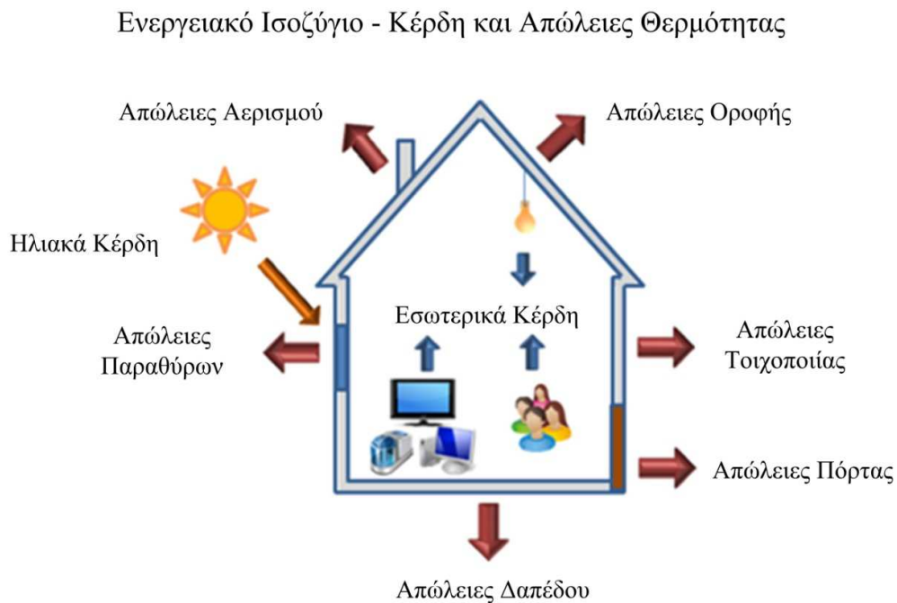
Εικόνα 1.1 - Σχηματική απεικόνιση θερμικών κερδών και απωλειών σε ένα κτίριο [6]
