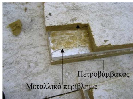
Εικόνα 5.3 - Τομή των VIP sandwich
