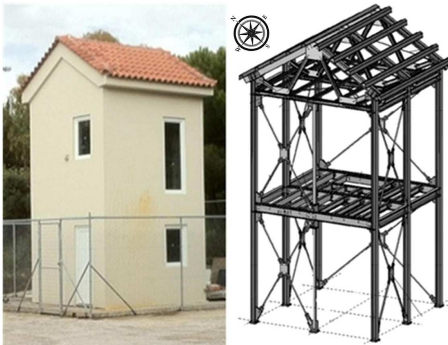
Εικόνα 5.1 - Άποψη του πειραματικού οικίσκου (mock up) και ο μεταλλικός σκελετός του
