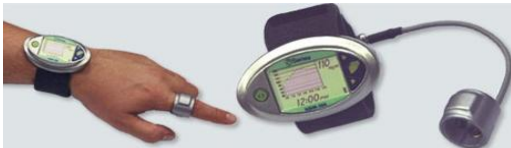
Σχήμα 2.2: ΔΣΜΓ που χρησιμοποιεί την τεχνολογία της φασματοσκόπησης εγγύς υπέρυθρου
