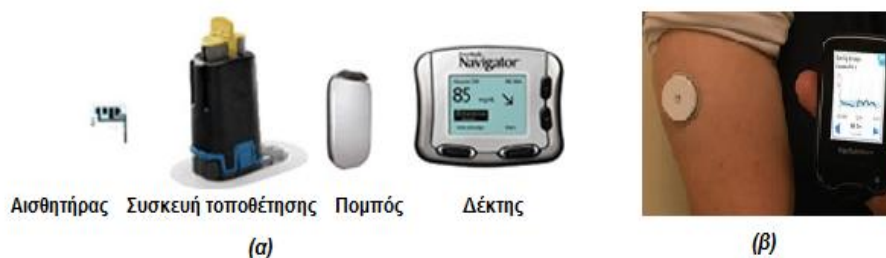
Σχήμα 2.7: (α) FreeStyle Navigator-Abbott. Από αριστερά προς τα δεξιά: ηλεκτροχημικός αισθητήρας που τοποθετείται υποδόρια, συσκευή για την τοποθέτηση του αισθητήρα, ραδιοφωνικός πομπός που συνδέεται με τον αισθητήρα και φορητή συσκευή-δέκτης που απεικονίζει τα αποτελέσματα, (β) FreeStyle Libre-Abbott
