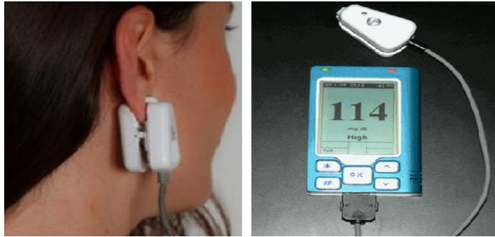
Σχήμα 2.4: GlucoTrack- ΔΣΜΓ που χρησιμοποιεί τη φωτοακουστική φασματοσκοπία [19]
