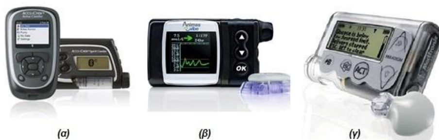
Σχήμα 2.13: Αντλίες με σετ έγχυσης. (α) Combo Insulin Pump (Accu-Chek) : Περιλαμβάνει συσκευή χειρός που λειτουργεί ως μετρητής γλυκόζης αίματος και εξασφαλίζει απομακρυσμένη ρύθμιση της αντλίας μέσω Bluetooth, (β) Vibe (Animas) : Παρέχει τη δυνατότητα άμεσης ενσωμάτωσης με τη ΔΣΜΓ Dexcom G4 PLATINUM (Dexcom) , (γ) MiniMed Paradigm Veo (Medtronic) : Διαθέτει ρύθμιση για αυτόματη διακοπή της χορήγησης ινσουλίνης ως απόκριση σε πολύ χαμηλά επίπεδα γλυκόζης, που μπορεί να αξιοποιηθεί όταν η αντλία χρησιμοποιείται με τη ΔΣΜΓ Enlite (Medtronic)
