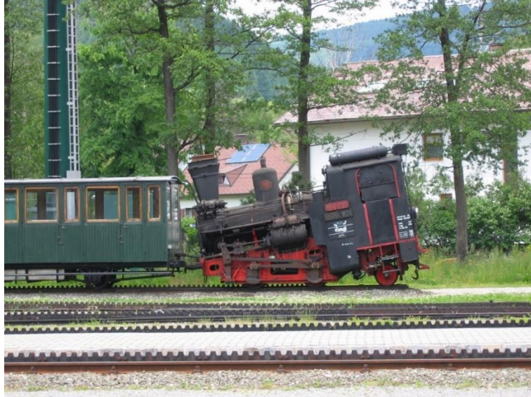
Σχήμα 1.3.2 Σιδηροδρομική ατμομηχανή με επικλινή λέβητα στον οδοντωτό σιδηρόδρομο του Schneeberg, Αυστρία [25]
