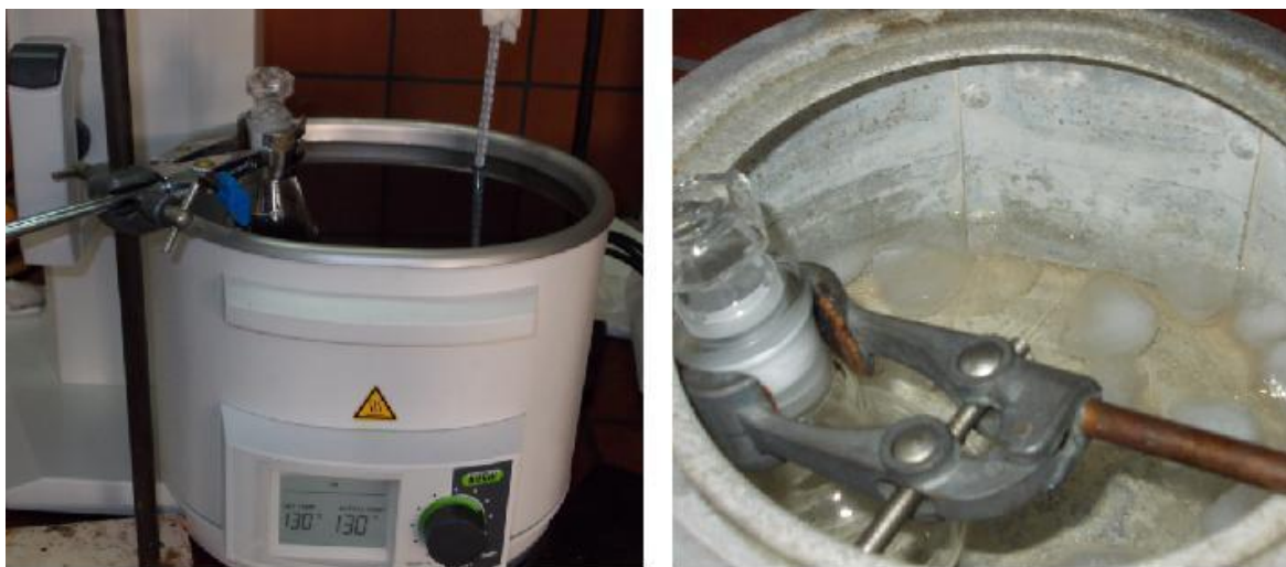
Εικόνα 18. Η απότομη ψύξη του τήγματος του PBS (quenching) προς περιορισμό της ανάπτυξης κρυσταλλικότητας
