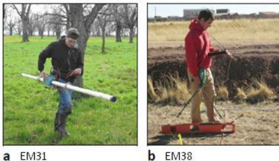
Σχήμα 2.26: Ενδεικτικά μηχανήματα Ηλεκτρομαγνητικής Μεθόδου. Στο αριστερό μέρος είναι το EM-31, και στο δεξί μέρος είναι το EM-38
