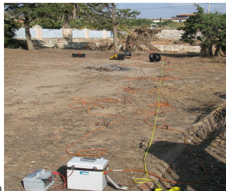
Σχήμα 4.9: α) Αποτύπωση των γεωηλεκτρικών τομών στην περιοχή ερευνάς, β) Το όργανο μέτρησης SYSCAL-Pro, γ) Γεωηλεκτρική τομή στην Περιοχή B.
