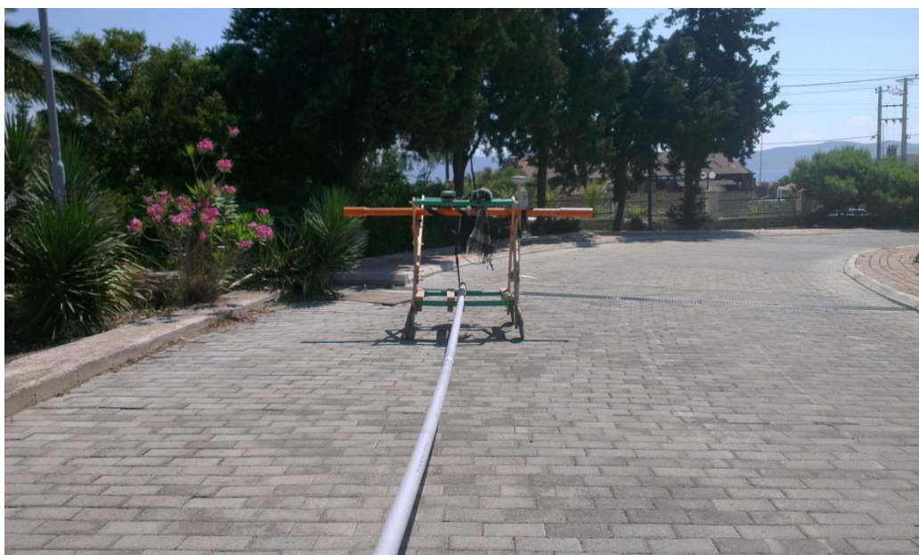
Εικόνα 4.4: Το ειδικό καρότσι με το ηλεκτρομαγνητικό όργανο «CMD»
