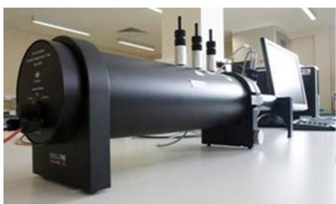
Σχήμα 6.3 Σύστημα ανηχοϊκού σωλήνα
