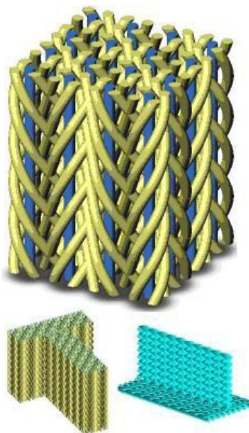
Σχήμα 1.8 Τριδιάστατα κλωστοϋφαντουργικά υφάσματα
