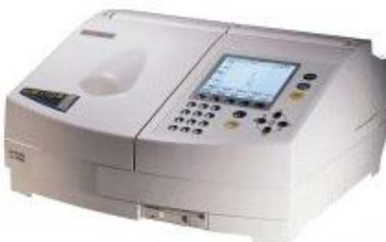
Εικόνα 42. Όργανο φασματοσκοπίας απορρόφησης υπεριώδους-ορατού (UV-Vis).
