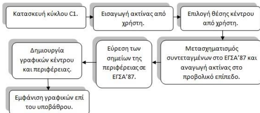
Διάγραμμα 5.3: Διαδικασία κατασκευής και λειτουργίας, γεωμετρικού εργαλείου σχεδίασης κύκλου.
