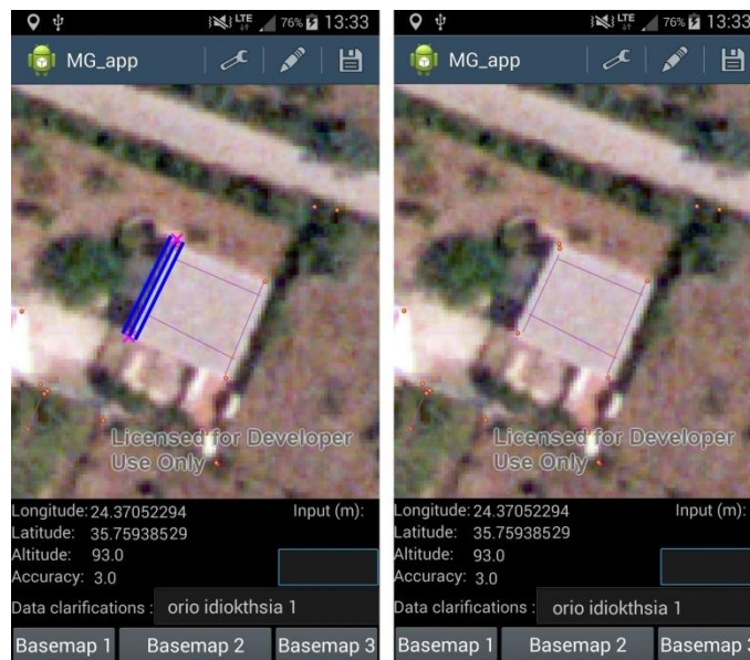
Εικόνα 6.13: Χρήση γεωμετρικού εργαλείου offset, για την εύρεση των ορίων του κτίσματος 1, τα οποία αποκρύπτονται από τις προεξοχές της οροφής του.
