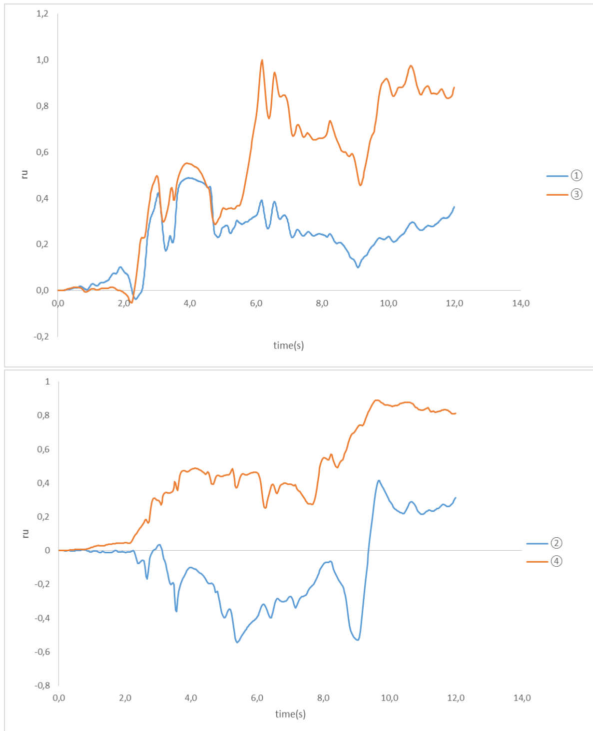
Σχήμα 3.12: : Χρονοϊστορία του λόγου υπερπίεσης πόρων r_u , των σημείων 1, 2, 3 και 4 που φαίνονται στο Σχήμα 3.3.
