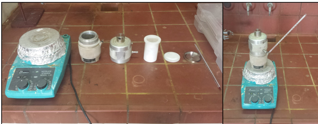
Εικόνα 2.20: Διάταξη χημικής διάβρωσης αποδιοργανωμένη (αριστερά), διάταξη χημικής διάβρωσης οργανωμένη και σε λειτουργία (δεξιά).
