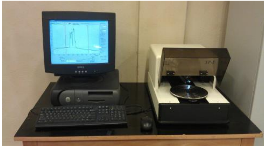
Εικόνα 2.17. Προφιλόμετρο επιφάνειας AMBIOS TECHNOLOGY XP-2
