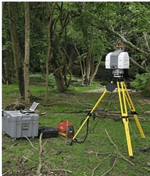
Σχήμα 2-2: Βασικά μέρη ενός Τρισδιάστατου Σαρωτή Laser Πηγή: Αναστασίου Α. Β., Πρέκα Δ., 2011
