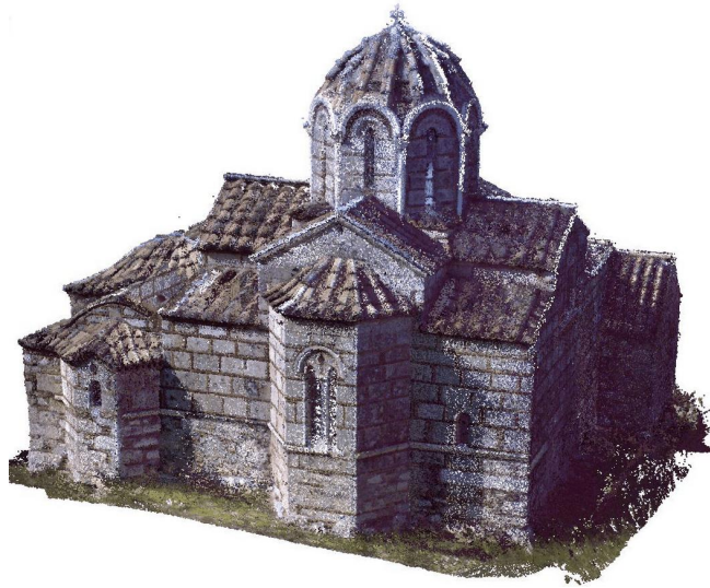
Σχήμα 2-1: Νέφος σημείων εκκλησίας Πηγή: Αστρολάβος Τεχνική Ο.Ε., 2013
