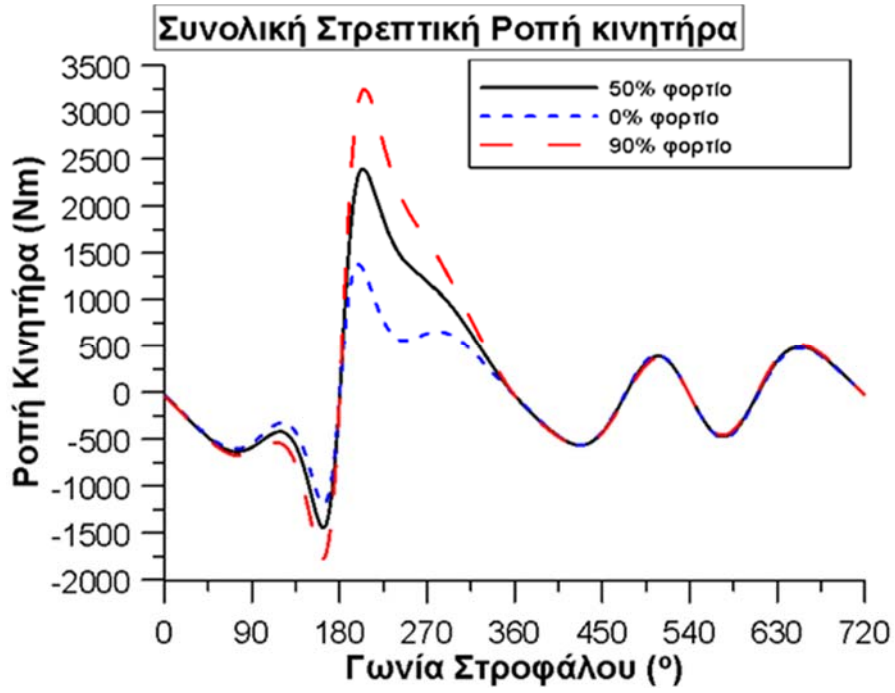
Σχήμα 5.9 Διάγραμμα στρεπτικών ροπών κινητήρα για τις τρεις περιπτώσεις φορτίων
