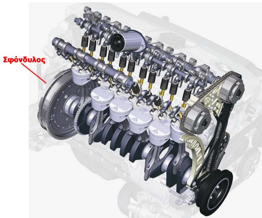
Σχήμα 3.3 Στροφαλοφόρος άτρακτος μοντέρνου εξακύλινδρου κινητήρα, με σφόνδυλο [6].
