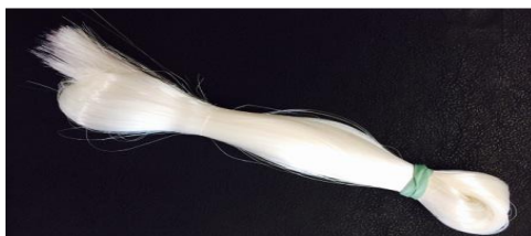
Εικόνα 7: Ίνες από πολυ(γαλακτικό οξύ)
