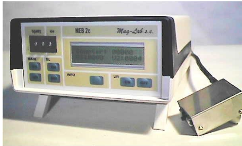
Εικόνα 2-6: Πειραματική διάταξη για τη μέτρηση του μαγνητικού θορύβου Barkhausen.
