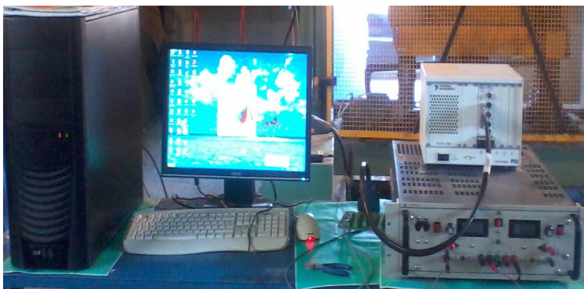
Εικόνα 2-10: Υστερησιογράφος του εργαστηρίου Μεταλλογνωσίας.
