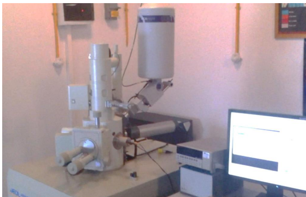
Εικόνα 2-19: Ηλεκτρονικό μικροσκόπιο σάρωσης (SEM) τύπου Jeol GSM 6380-LV.
