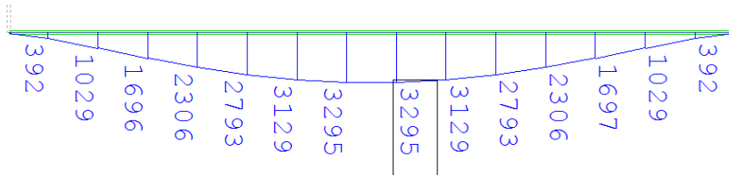
Σχήμα 9 - 7 (α) : Ροπή σχεδιασμού ανοίγματος σε συνδυασμό κόπωσης
