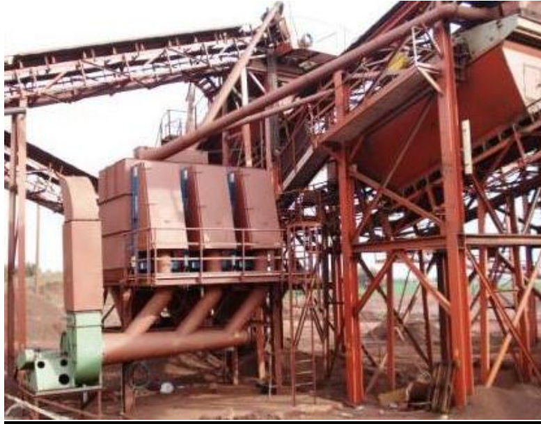
Σχήμα 3.10. Σύστημα αποκονίωσης εργοστασίου Λάρυμνας
