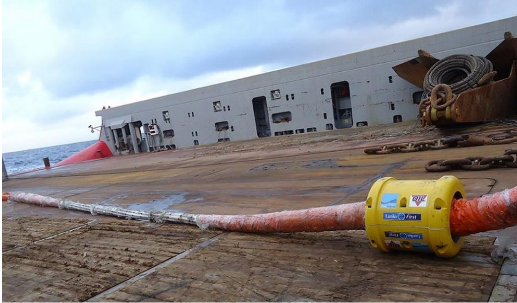
Εικόνα 3.25: Τένοντες με ειδικό σύνδεσμο επέκτασης (firstsubsea)
