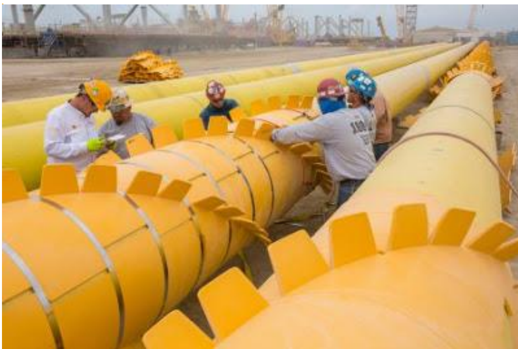
Εικόνα 3.26: Τένοντες με ειδική διαμόρφωση για μείωση των κραδασμών και αποφυγή συντονισμού
