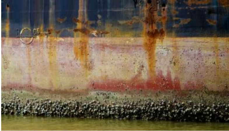
Εικόνα 20- Βιόρπανση στη γάστρα του πλοίου
