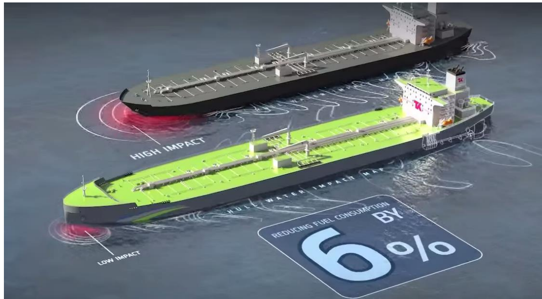
Εικόνα 13 - Αφαίρεση βολβού πλώρης
