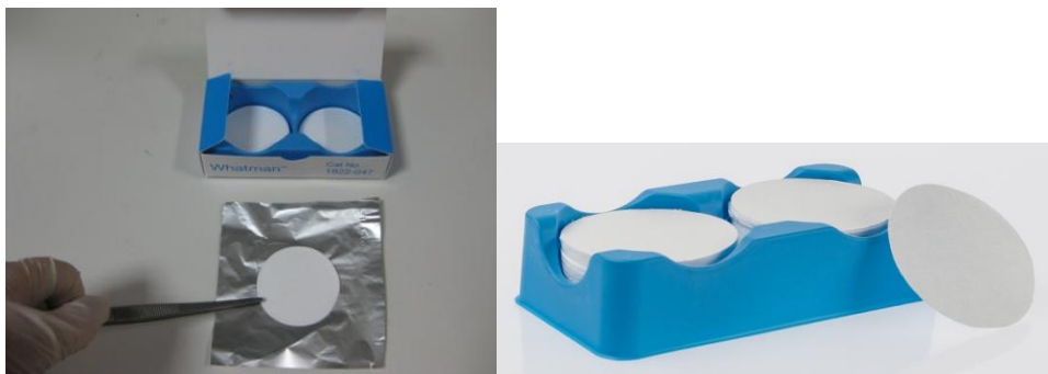
Εικόνα 3-19 : Φίλτρα GF/C με διάμετρο πόρων 1,2 μm
