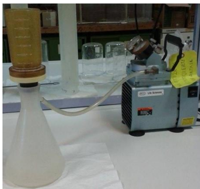
Εικόνα 3-20 : Μονή συσκευή διήθησης με χρήση αντλίας κενού
