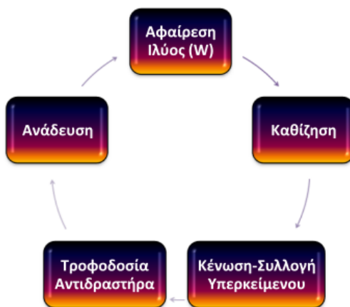
Διάγραμμα 3-1 : Κύκλος λειτουργίας αντιδραστήρων
