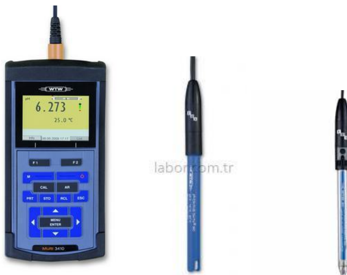
Εικόνα 3-14 : Πολύμετρο (αριστερά), ηλεκτρόδιο pH (μέση), ηλεκτρόδιο REDOX (δεξιά)
