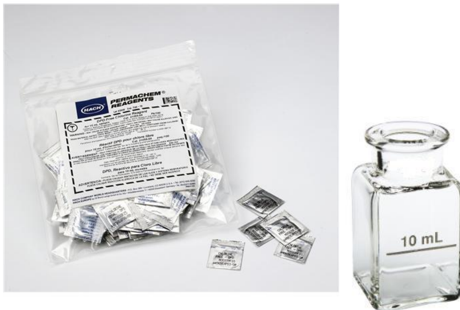
Εικόνα 3-31: Φακελάκι σκόνης SulfVer 4 (αριστερά) και τετραγωνικό φιαλίδιο (δεξιά)
