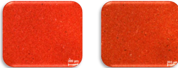
Εικόνα 36: Εικόνες οπτικής μικροσκοπίας (x100). Αριστερά: Εμπορική αντιρρυπαντική επικάλυψη. Δεξιά: Τροποποιημένη αντιρρυπαντική επικάλυψη με ενσωμάτωση CNTs
