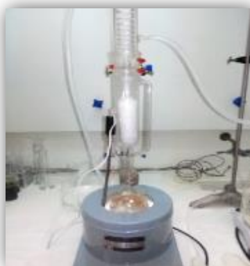
Εικόνα 16: Εκχύλιση Soxhlet για καθαρισμό των CNTs από υπολείμματα καταλύτη
