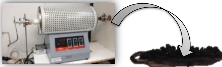
Εικόνα 15: Αντιδραστήρας T-CVD για τη σύνθεση των CNTs και παραλαμβανόμενο προϊόν
