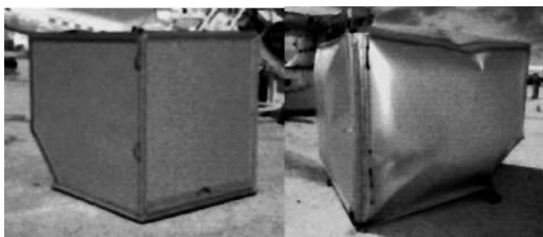
Εικόνα 4. Το ECOS-3 πριν και μετά τα τεστ εκρηκτικών.
