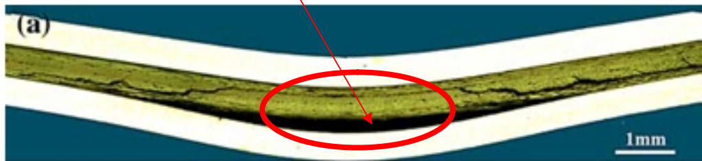
Εικόνα 1. Εσωτερικές βλάβες δοκιμίου GLARE 5-2/1 μετά της κρούσης [72].
