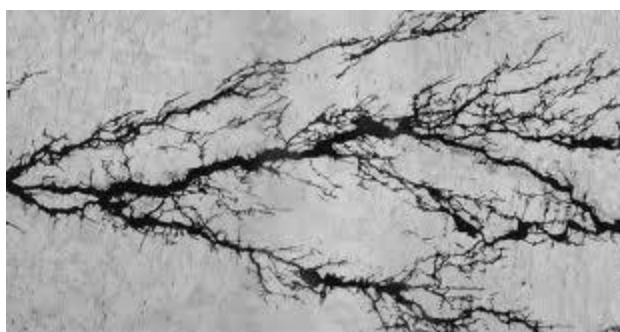
‘Ψαθνή θραύση από διάβρωση με μηχανική καταπόνηση σε μικροσκόπιο’
