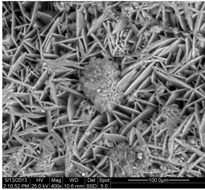
Εικόνα 1.2.1-1: Εικόνα SEM: Ανάπτυξη κρυστάλλων γύψου (25)
