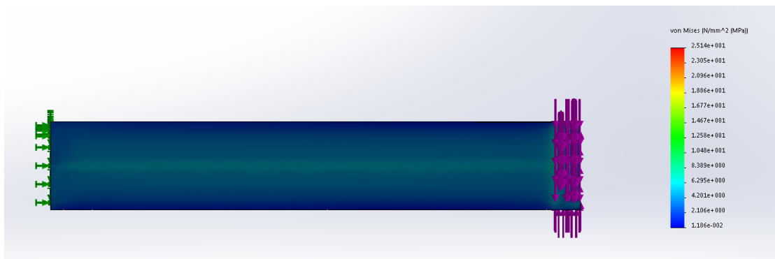
Εικόνα 3.3.3.7 : Τασικό πεδίο λόγω στρέψης του επενεργητή
