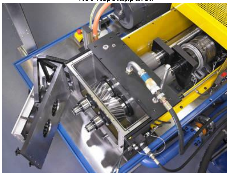
Εικόνα 1.2.1.3 : Βαθμίδα οδοντωτών τροχών με ελικοειδείς οδόντες προς έλεγχο σε ένα FZG Gear Test Rig
