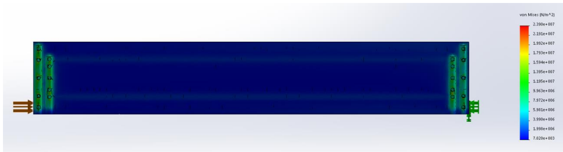
Εικόνα 3.3.3.2 : Τάσεις λόγω αξονικής καταπόνησης του επενεργητή
