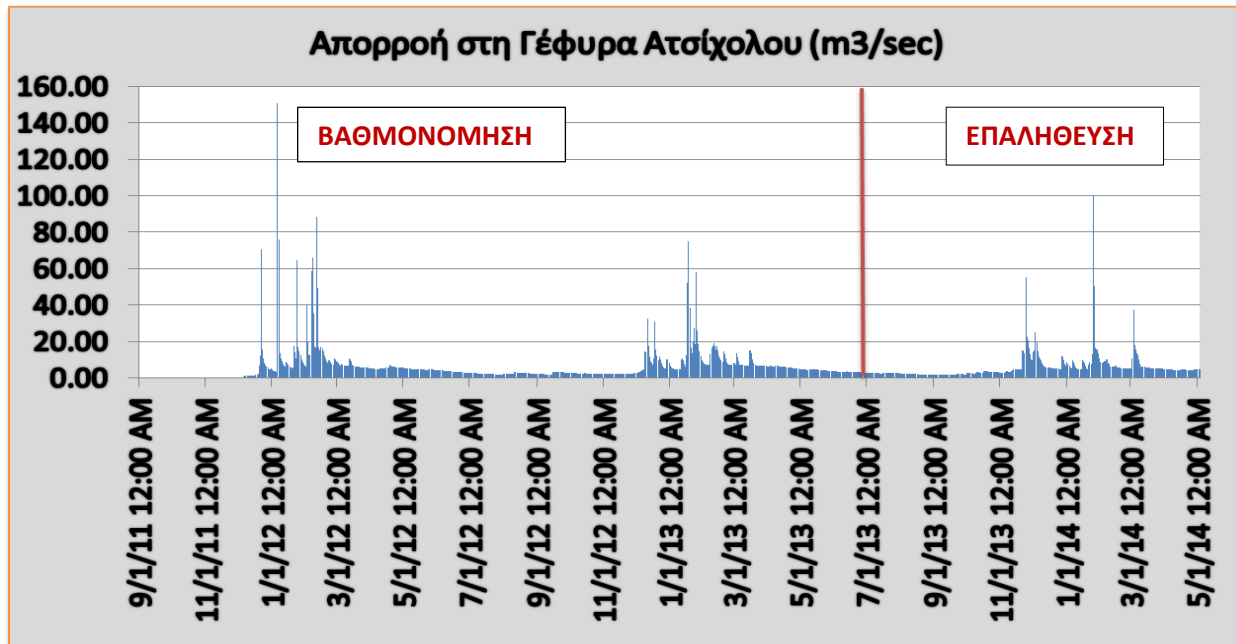
Σχήμα 5.2: Ο διαχωρισμός (data-split) της περιόδου προσομοίωσης σε περίοδο βαθμονόμησης και επαλήθευσης, όπως αναπαρίσταται στην προσομοιωμένη απορροή για την λεκάνη του Λούσιου.
