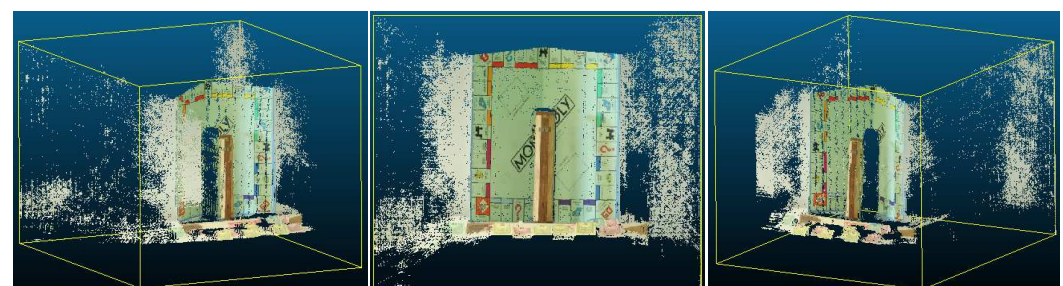
Εικόνα 7.19. Ανακατασκευή από τη μέθοδο Census+P 2r +SGM. Σκηνή Monopoly .
