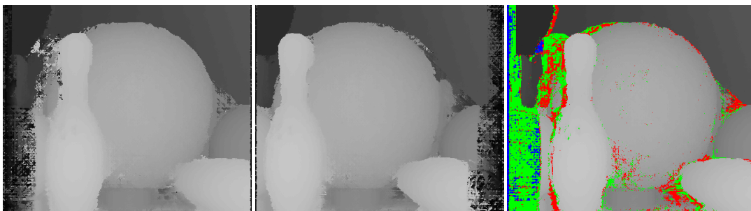
Εικόνα 7.40. Χάρτες παράλλαξης αριστερής και δεξιάς εικόνας και χάρτης παράλλαξης όπου με χρώμα επισημαίνονται τα σημεία που δεν πέρασαν τον έλεγχο συμβατότητας. Σκηνή Bowling2 .
