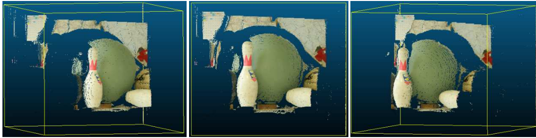
Εικόνα 7.28. Ανακατασκευή μετά από την εφαρμογή μάσκας αποκρύψεων από τη μέθοδο Census+P_{2r}+SGM . Σκηνή Bowling2 .
