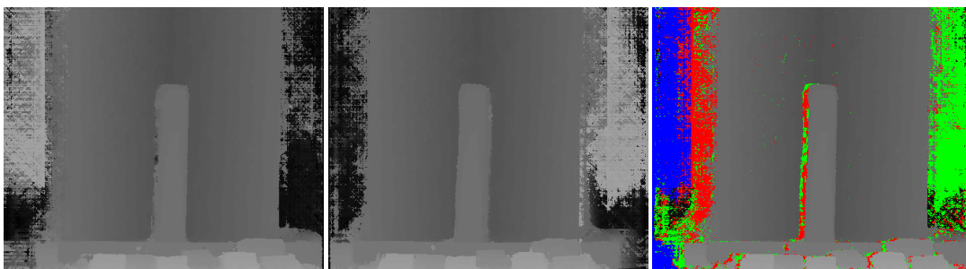
Εικόνα 7.41. Χάρτες παράλλαξης αριστερής και δεξιάς εικόνας και χάρτης παράλλαξης όπου με χρώμα επισημαίνονται τα σημεία που δεν πέρασαν τον έλεγχο συμβατότητας. Σκηνή Monopoly .
