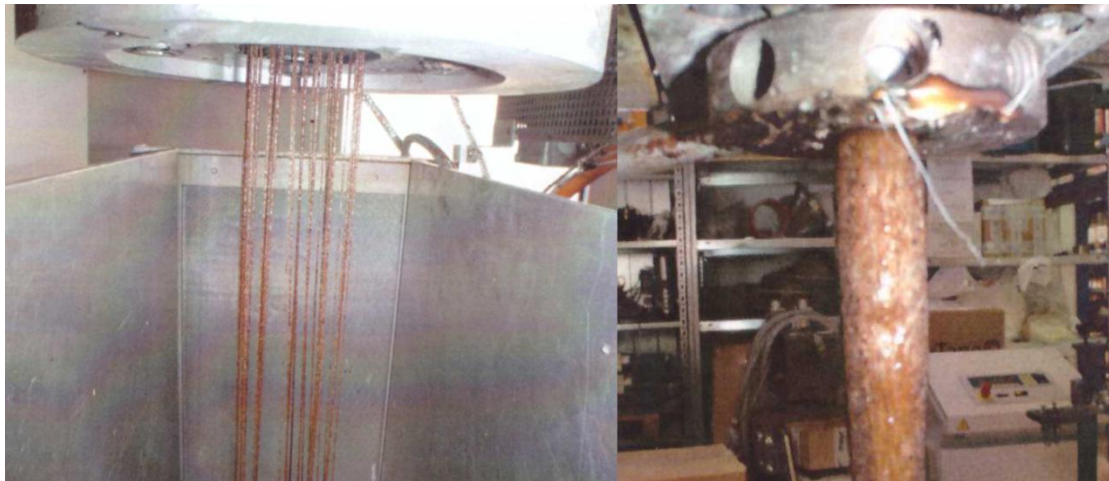
Εικόνα 60: Έξοδος υλικού από τη φιλέρα και από βαλβίδα της αντλίας στη δεύτερη θέση
