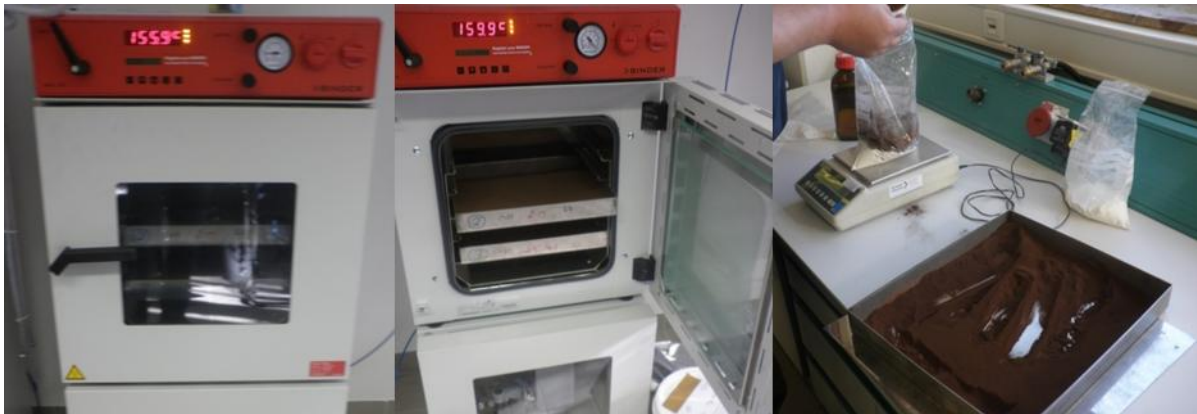
Εικόνα 63: Θερμική επεξεργασία της λιγνίνης υπό κενό και ανάμειξη του μείγματος
