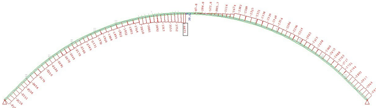
Εικ. 3.14 : Μέγιστη αξονική δύναμη στο τόξο - φόρτιση 305 (σεισμός κατά Χ)
