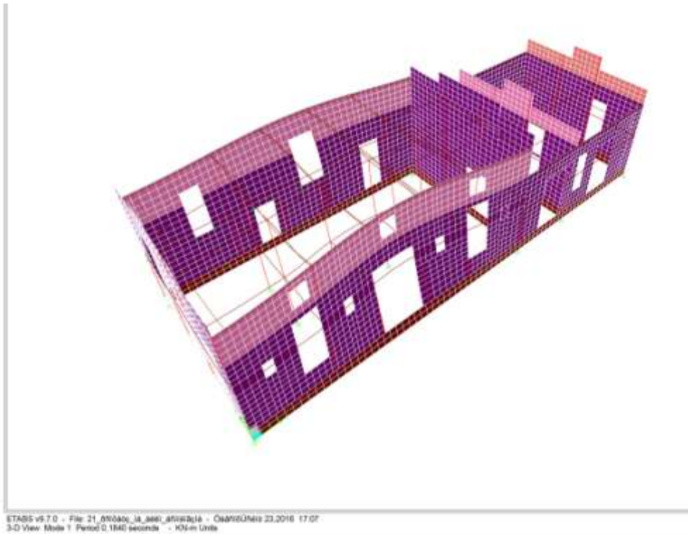
Εικόνα 50, Κτήριο 1, θεμελιώδεις ιδιοπερίοδοι κατά χ και γ, T= 0.31 και 0,15 sec αντίστοιχα
